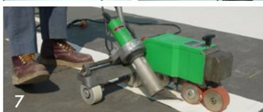
NOTA: Las temperaturas elevadas que son generadas por las soldadoras automáticas y portátiles pueden causar lesiones. Tenga cuidado y evite el contacto personal con las puntas de la soldadora, el aire caliente generado y los puntos soldados a lo largo de las costuras hasta que se enfíen.
