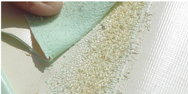
**Soldadura deficiente o tipo "velcro"** indica la presencia de humedad durante el proceso de soldadura.
