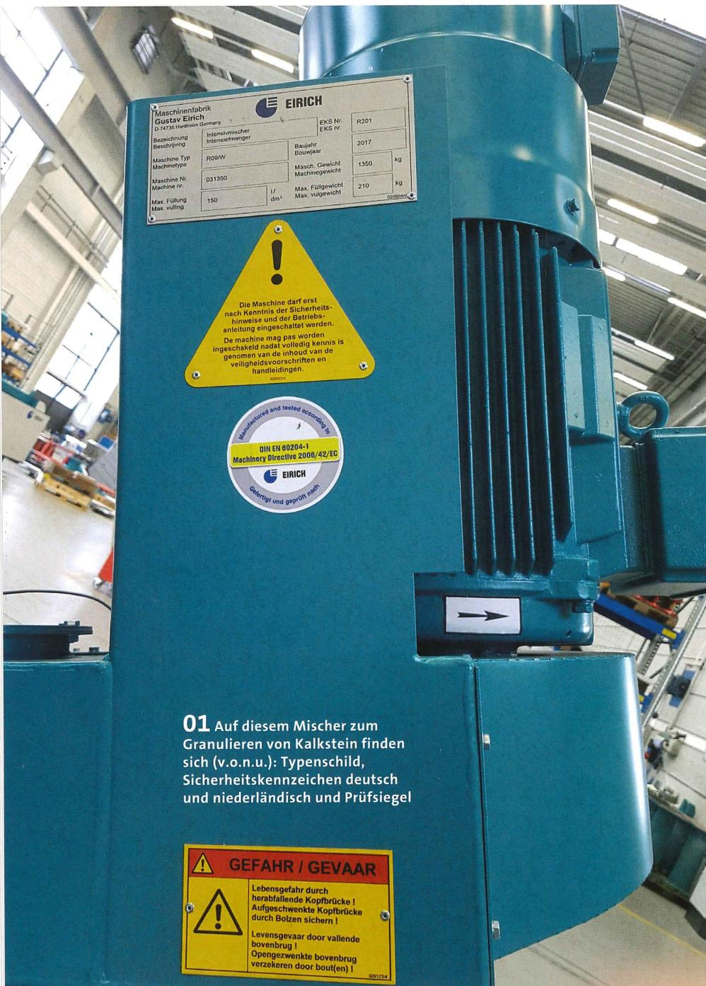
**01** Auf diesem Mischer zum Granulieren von Kalkstein finden sich (v.o.n.u.): Typenschild, Sicherheitskennzeichen deutsch und niederländisch und Prüfsiegel
