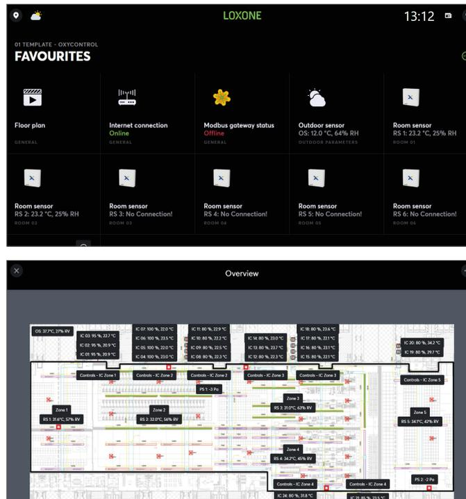
**CLEVERE BETRIEBSARTEN** Der OxyControl misst die Innen- und Außenbedingungen, um den komfortabelsten und effizientesten Kühlmodus zu wählen. Bei Ausstattung mit einem Wärmerückgewinnungsmodul ist eine Lüftung im Winter möglich, wobei die interne Abwärme genutzt wird, um angenehme Vorlauftemperaturen zu gewährleisten.
