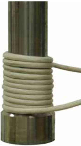
Bobina montata sotto un convogliatore per riscaldare barattoli di metallo.
