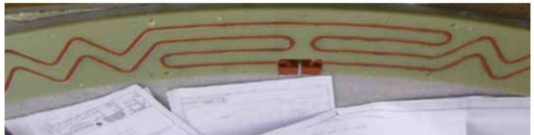
Unterhalb eines Förderers angebrachte Spule zur Erwärmung von Metall Dosen.
