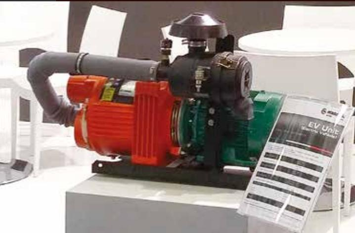
Ciò significa un funzionamento di un gruppo vite che varia da 20.000 a 30.000 ore, che si riduce a 12.000 quando la macchina è sottoposta a vibrazioni, calore e residui, tipici di qualsiasi applicazione ferroviaria.
