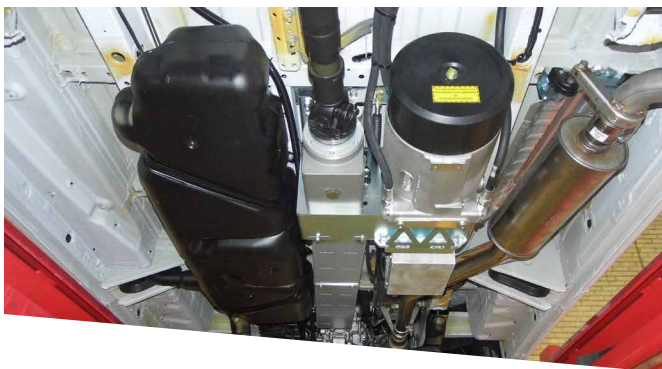
Vor (von oben) und Nachher - der Kompressor (hier ohne Generator) im Unterflurbereich eines Fahrzeugs von Thermo King Berlin Transportkälte GmbH.
