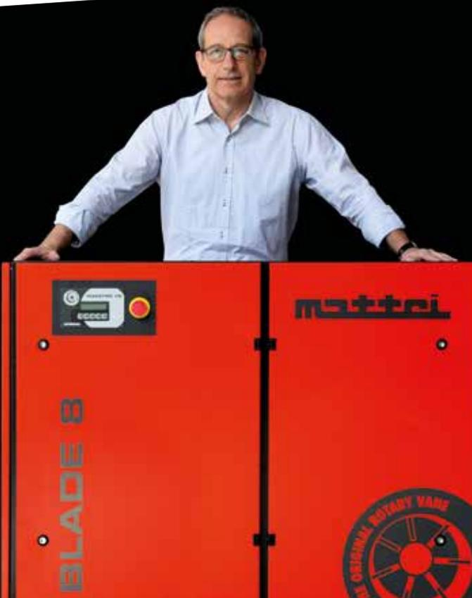
Mattei crede molto nell'accoppiamento diretto, perché garantisce elevati standard di efficienza e affidabilità e riduce gli interventi di manutenzione. Proprio per questo motivo, la Blade 8-12 è ad accoppiamento diretto esattamente come la sorella maggiore Blade 15-22.
