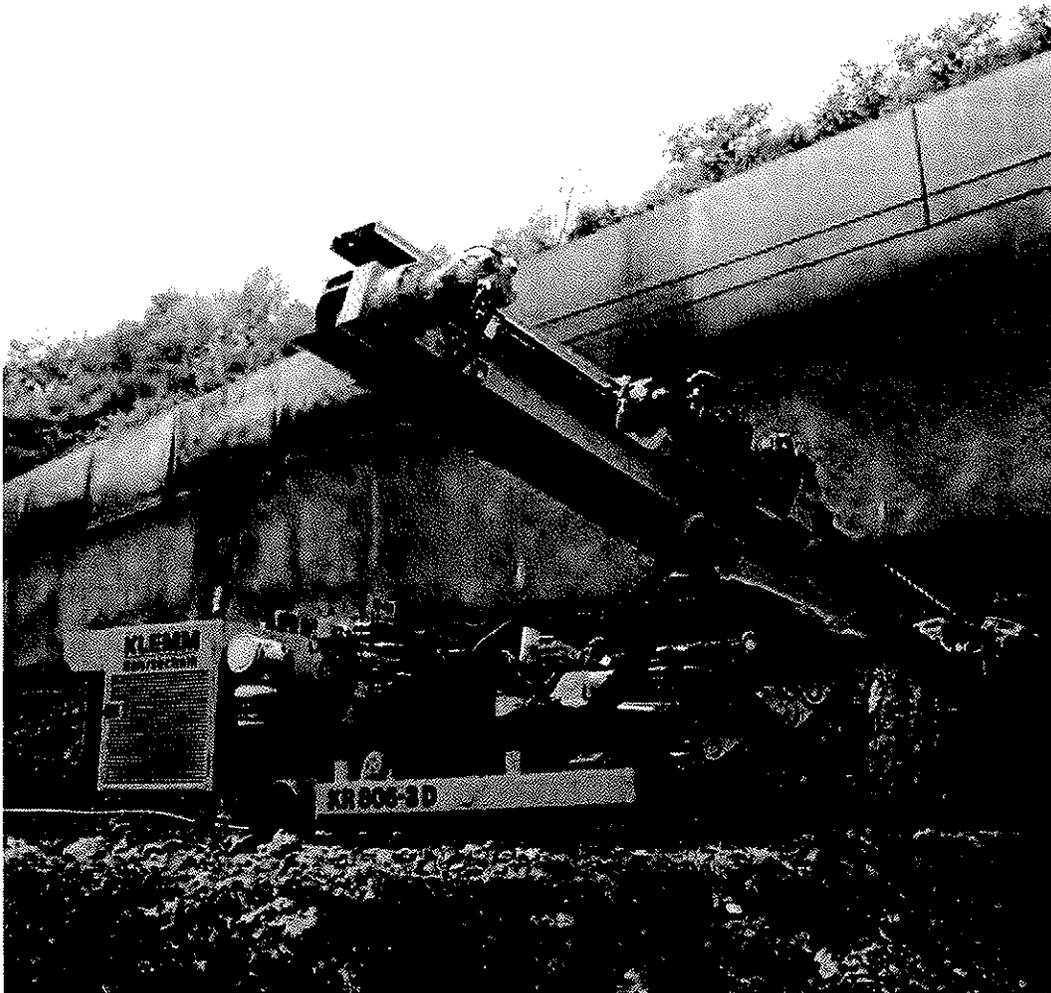
**KR 806-3D** Bohrergerät mit Doppelkopfböhranlage KH 20 / KD 1215 R
