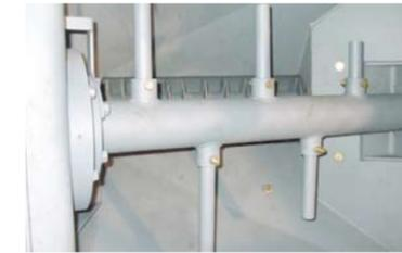
固化材の架橋現象やラットホールの発生を防止して添加精度を向上します。回転速度制御により、均一な固化材排出を実現します。
