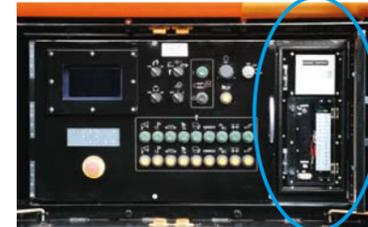
処理土量、固化材量を作業時間ごと、もしくは作業日ごとで出力するためのプリンタを標準装備しました。
