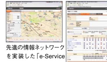
先進の情報ネットワークを実装した「e-Service Owner's site」によって、機械の予防保守管理は、電子情報へと変革します。私たち日立建機は、機械情報をお客様と共有することで、定期点検時期やオイル交換時期の判断要素とします。また、万が一機械に異常が発生した場合でも、警告情報から原因を診断し、位置情報により機械の場所を地図上で確認できます。お客様の休車時間を低減し、迅速で的確なサービスを目指しております。
