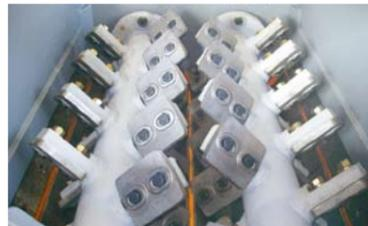
混合機には「2 軸パドルミキサ」方式を採用し、さまざまな性状の原料土に対応します。
