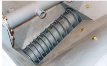
シュート形状の変更、スクリューフィーダの大径化により固化材の排出性を向上しました。
