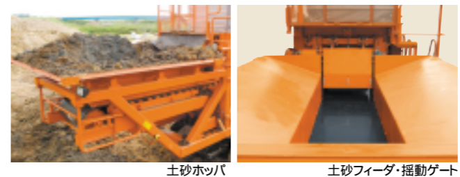
土砂ホッパ 土砂フィーダ・揺動ゲート
