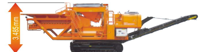
写真は、固化材ホッパを縮め、固化材ホッパ部の手すりを外した状態です。
