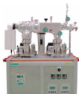
呼気ガス測定装置（ブレスマス） （提供：国立研究開発法人日本原子力研究開発機構）
