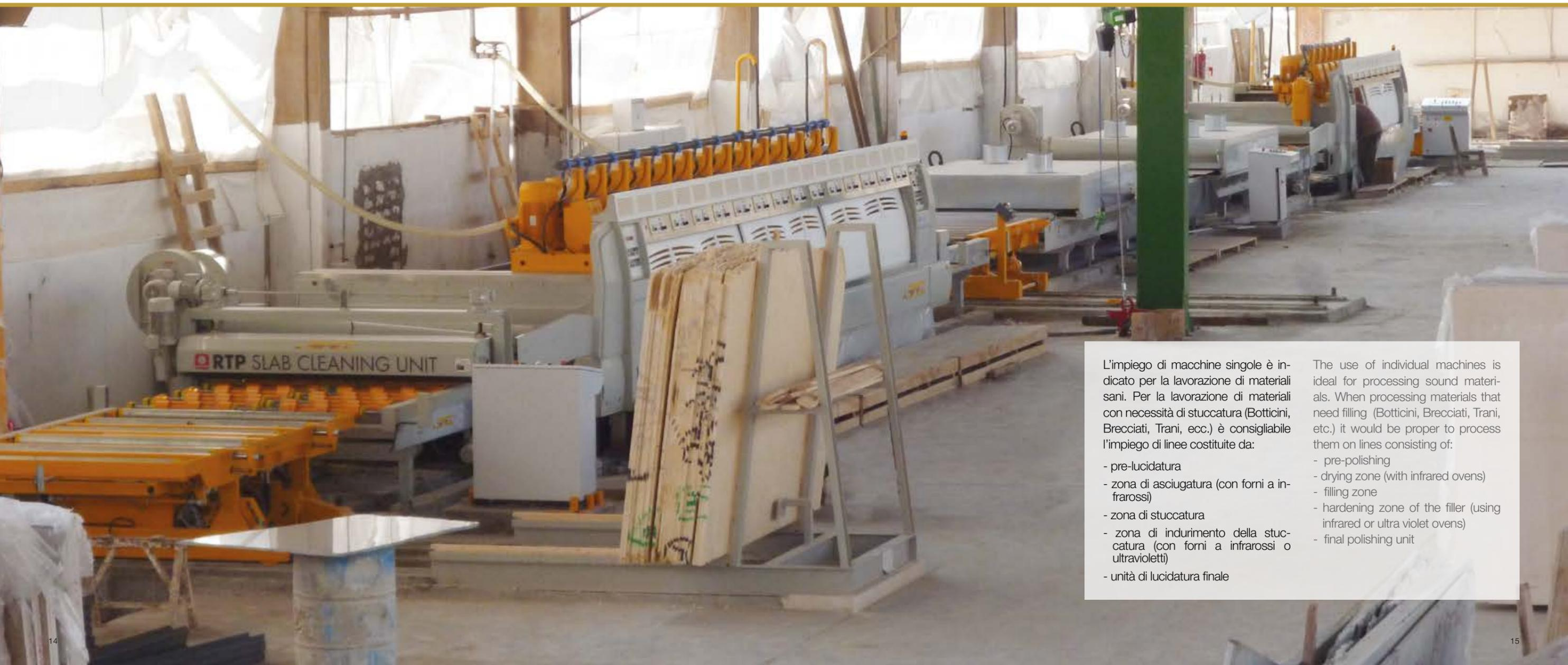
L'impiego di macchine singole è indicato per la lavorazione di materiali sani. Per la lavorazione di materiali con necessità di stuccatura (Botticini, Brecciate, Trani, ecc.) è consigliabile l'impiego di linee costituite da:
