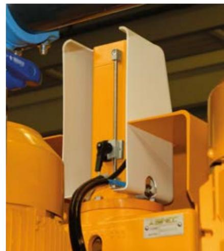
Dispositivo ad encoder lineare per il controllo consumo abrasivi completamente automatico.
