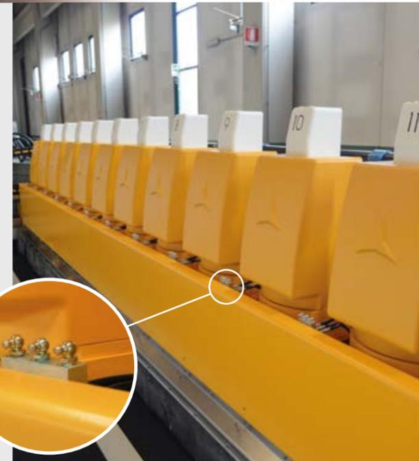
Ogni mandrino dispone di un proprio sistema di lubrificazione generale, collocato in modo da essere facilmente raggiungibile dall'operatore.
