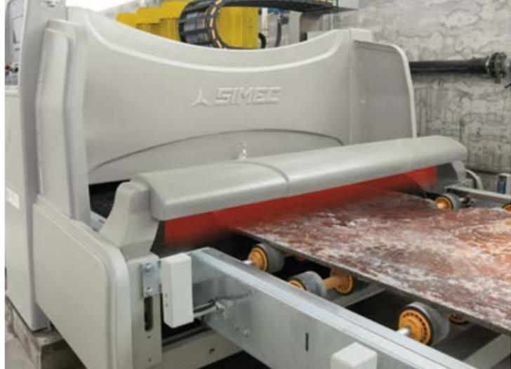
Sopra: particolare del sistema di lettura del profilo lastra a fotocellule SEL. Il profilo delle lastre viene letto con una precisione di 100 punti per decimetro quadro.
