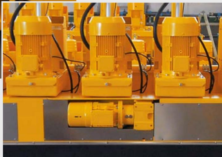
A destra: particolare del motore controllato da inverter che imprime il movimento di traslazione al ponte portamandri assicurando fluidità di movimento e regolazione delle accelerazioni e decelerazioni.
