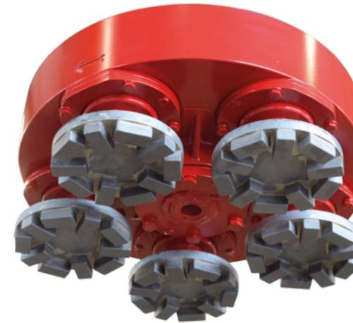
È una testa particolarmente flessibile, impiegabile, con utensili di grana adeguata, sia in fase di sgrossatura che lucidatura. SIMEC ha realizzato tre versioni del prodotto per soddisfare ogni tipologia di lavoro; queste sono ottenute grazie ad una differente inclinazione dei piattorelli portautensili.
