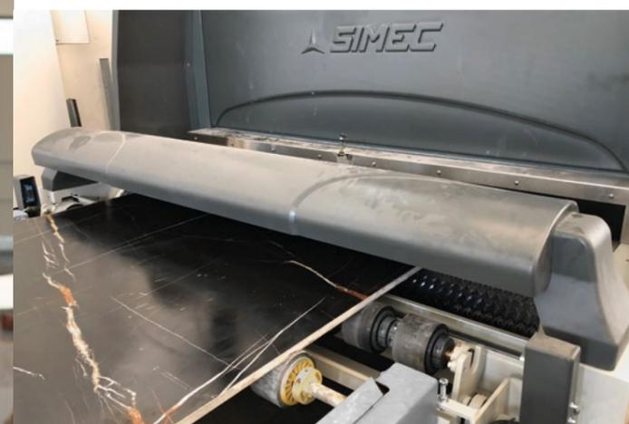
Il profilo delle lastre viene letto con una precisione di 100 punti per decimetro quadro.
