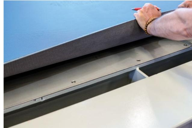
Sopra: particolare dei piani anti-usura intercambiabili in acciaio.
