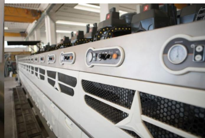
Per agevolare il lavoro dell'operatore, ogni mandrino dispone frontalmente di una serie di comandi e controlli di tipo analogico.
