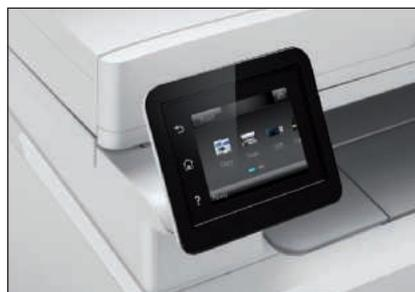
Der HP Color Laserjet Pro MFP M282nw wird über ein Farb-Touch-Display gesteuert.
