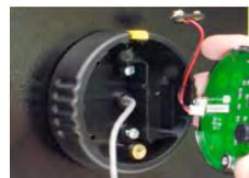
10. Insérez le câble de la pile dans la fente du socle du compartiment du câble de la pile et placez le reste du câble dans le compartiment.
