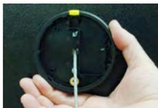
6. En appuyant sans forcer sur le câble, placez le clavier contre la porte, fixez avec les deux vis fournis. Ne dépassez pas un couple de torsion de 15 pouces-livres (1,695 Nm).
