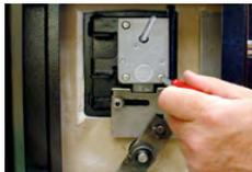
4. Placez l'extrémité du câble de verrouillage à travers la porte du coffre-fort par l'intérieur. En appuyant sans forcer sur le câble, insérez la serrure et sa tige dans la porte du coffre-fort afin de la fixer sur la plaque de montage avec les trois vis fournis.
