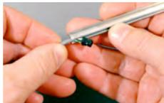
2. Insérez le câble de verrouillage dans la fente de la tige comme l'indique la photo. Puis glissez le câble sur la longueur de la fente.
