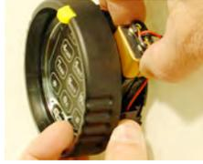
14. Repoussez l'anneau du clavier sur le socle et tournez dans le sens des aiguilles d'une montre jusqu'au clic. Testez le système de verrouillage au moins trois fois porte ouverte avant de fermer le coffre-fort.
