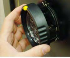
13. Pour installer la pile, tirez légèrement sur la languette jaune, tournez l'anneau du clavier dans le sens inverse des aiguilles d'une montre et tirez-la vers vous. L'anneau révélera le connecteur de la pile. Branchez la pile et placez-la dans son compartiment.
