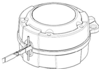
Bult som håller vävbandslinan på plats
