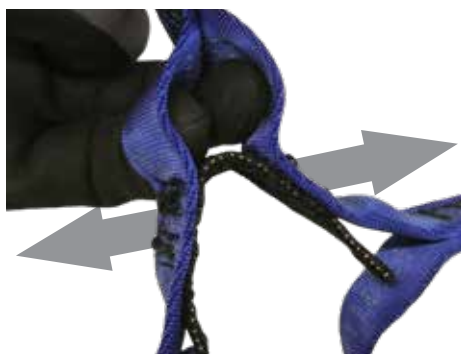
Inspección de la cinta de activación
