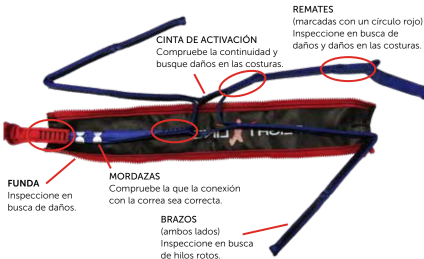
Inspección del sistema de protección contra sobrecargas de RipCord
