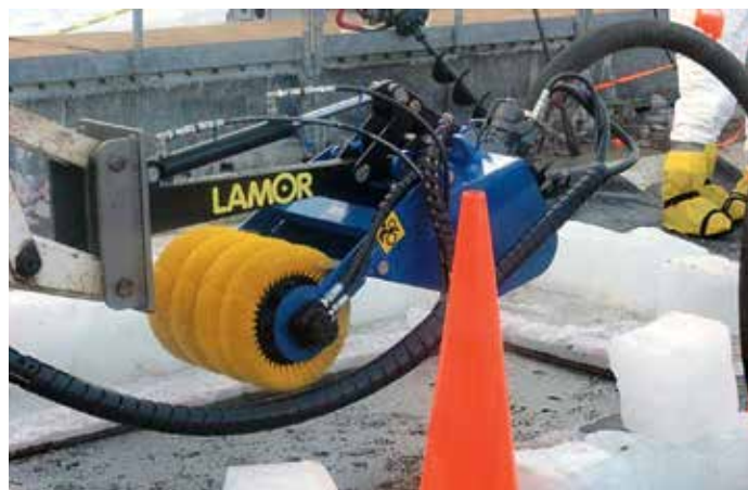
Lamor Recovery Bucket 40 (LRB 40), keräyskauha, kapasiteetti: 19 m 3 /h
