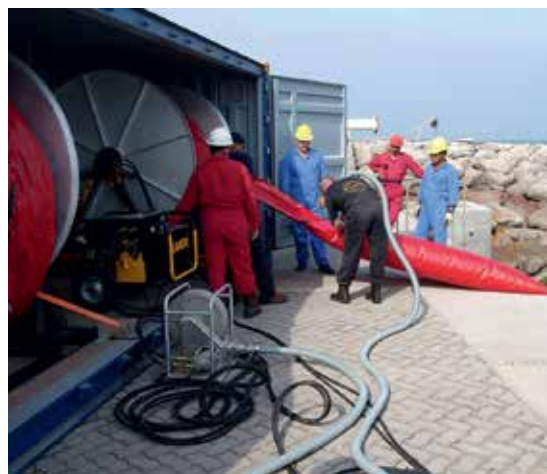
Ilmatäytteinen kevyt puomi (PVC/PU ja neopreeni), korkeus: 650–1650 mm
