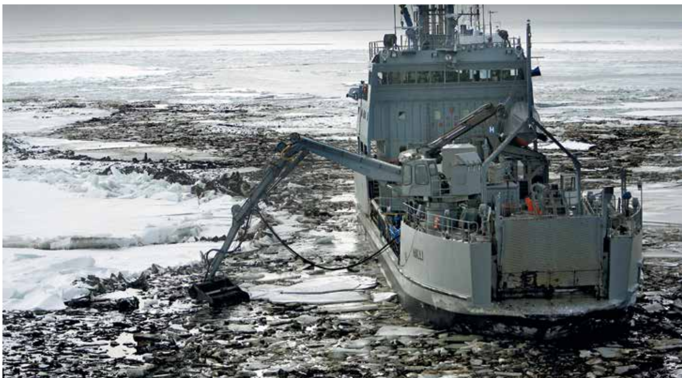
Bucket Skimmer (LRB 250), kauhakeräin, kapasiteetti: 140 m 3 /h
