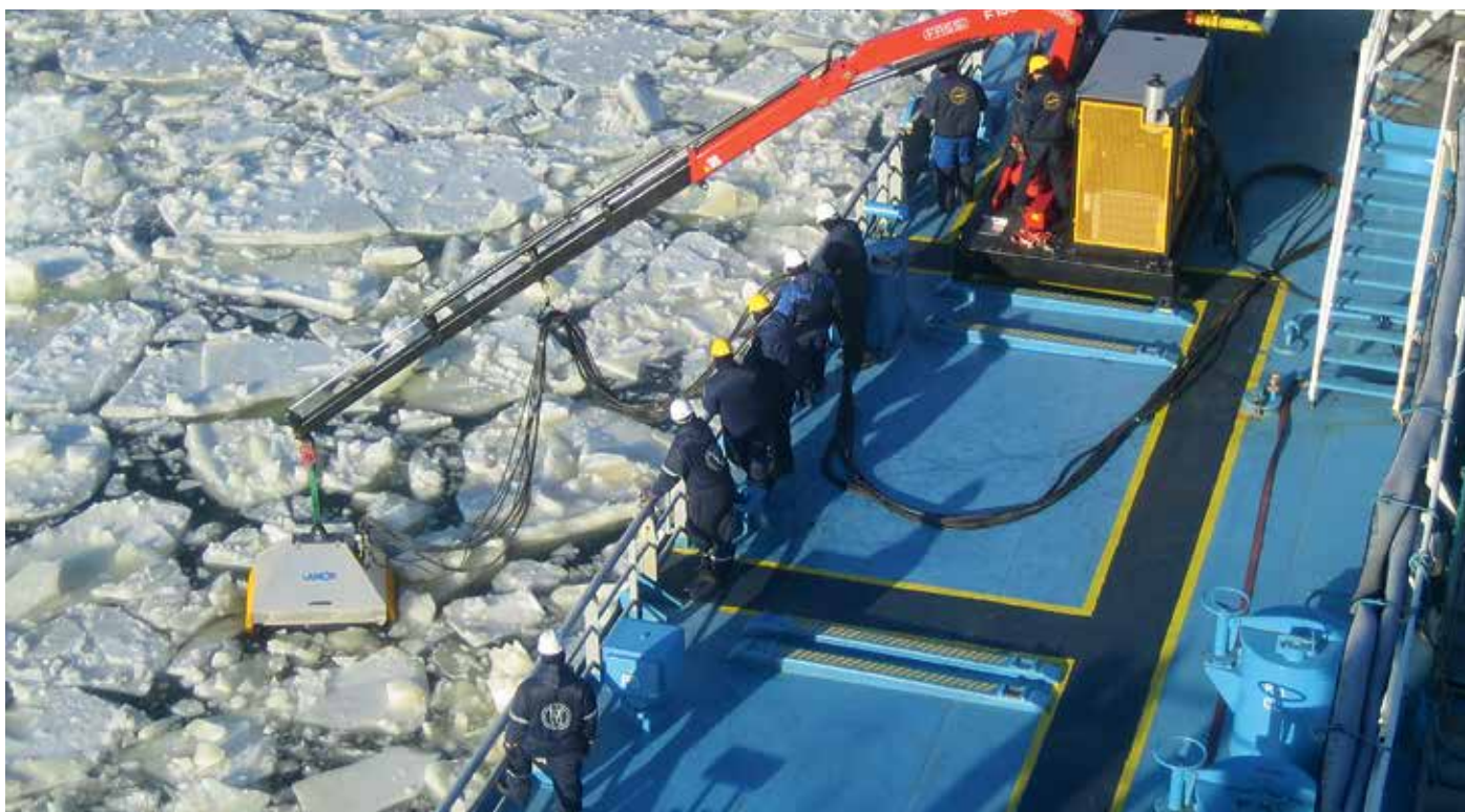
Arctic Skimmer (LAS 125), arktinen keräin, kapasiteetti: 125 m 3 /h
