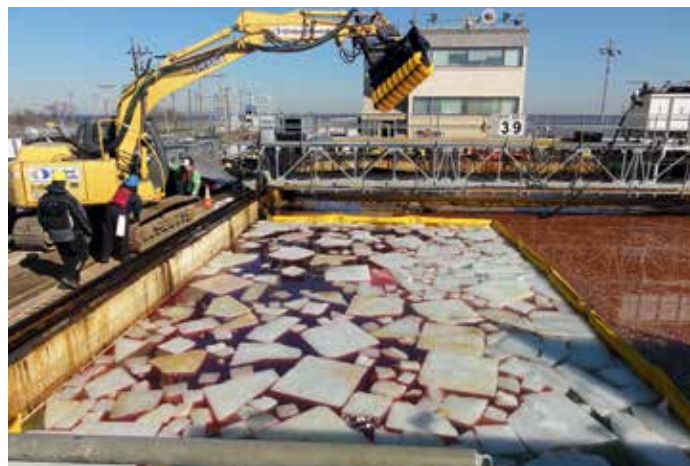
Bucket skimmer (LRB 150), kauhakeräin, kapasiteetti: 115 m 3 /h
