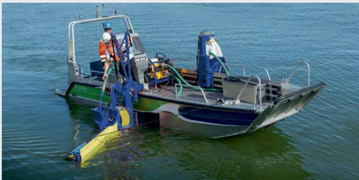
Side collector / MiniBagger, sivukeräin, kapasiteetti: 10 m 3 /h
