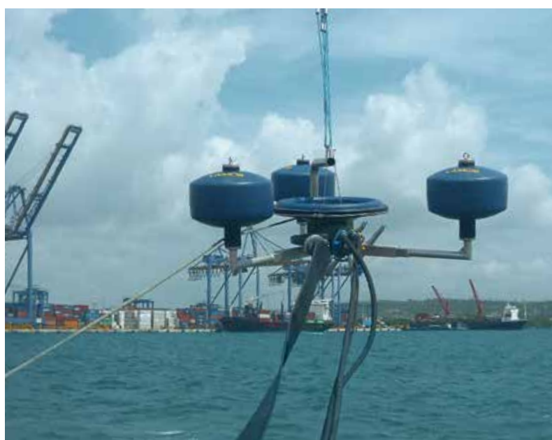
Weir Skimmer 800 (LWS 800), kauluskeräin, kapasiteetti: 112,2 m 3 /h
