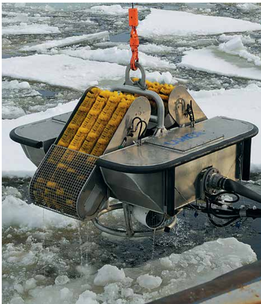
Free Floating 100 (LFF100), vapaasti kelluva keräin, kapasiteetti: 111 m 3 /h
