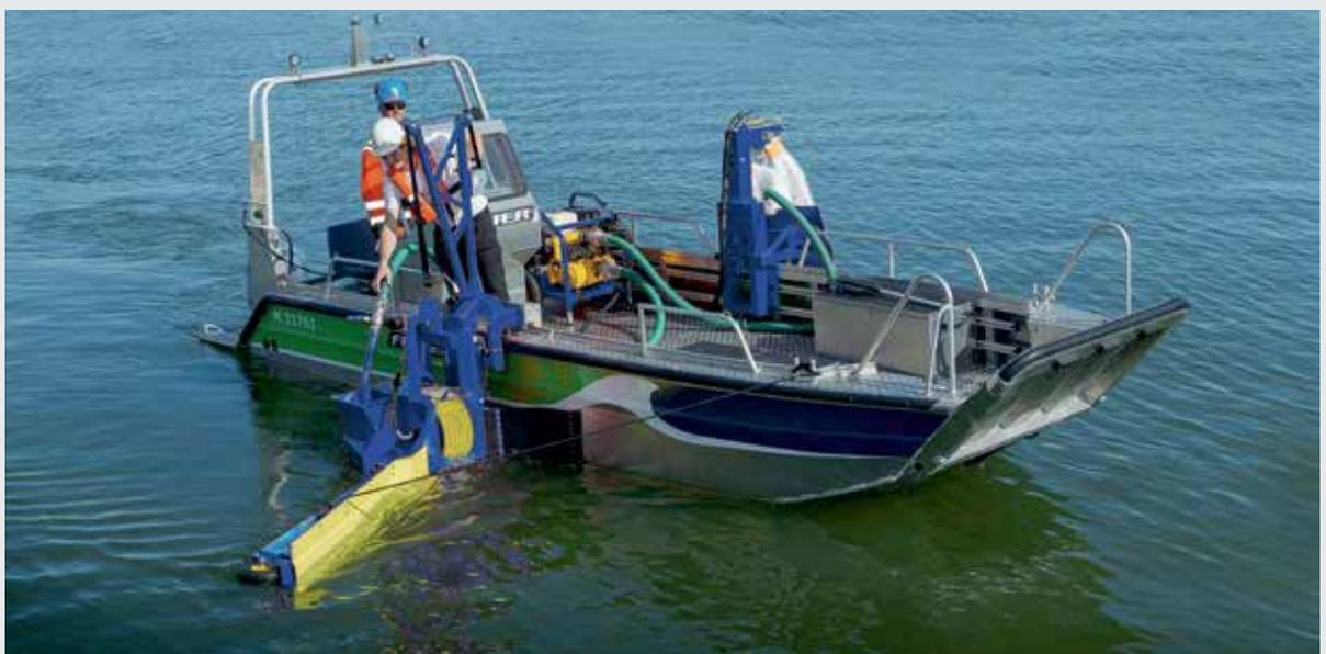
Seitenkollektor / MiniBagger, Kapazität: 10 m<sup>3</sup>/h (44 gpm)
