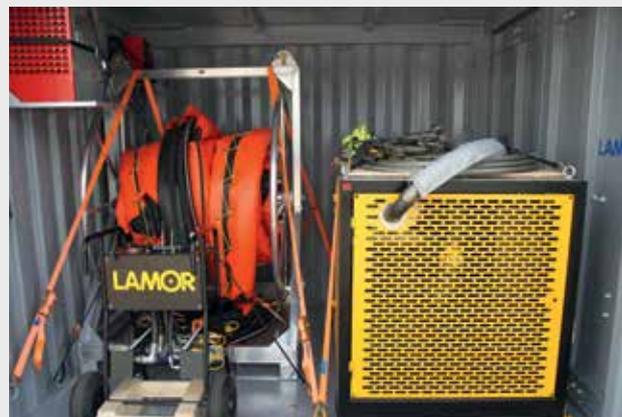
Containerisierte Lösung einschließlich Antriebsaggregat, Schlauchhaspel und Hydraulik-Steuerpult für Skimmer
