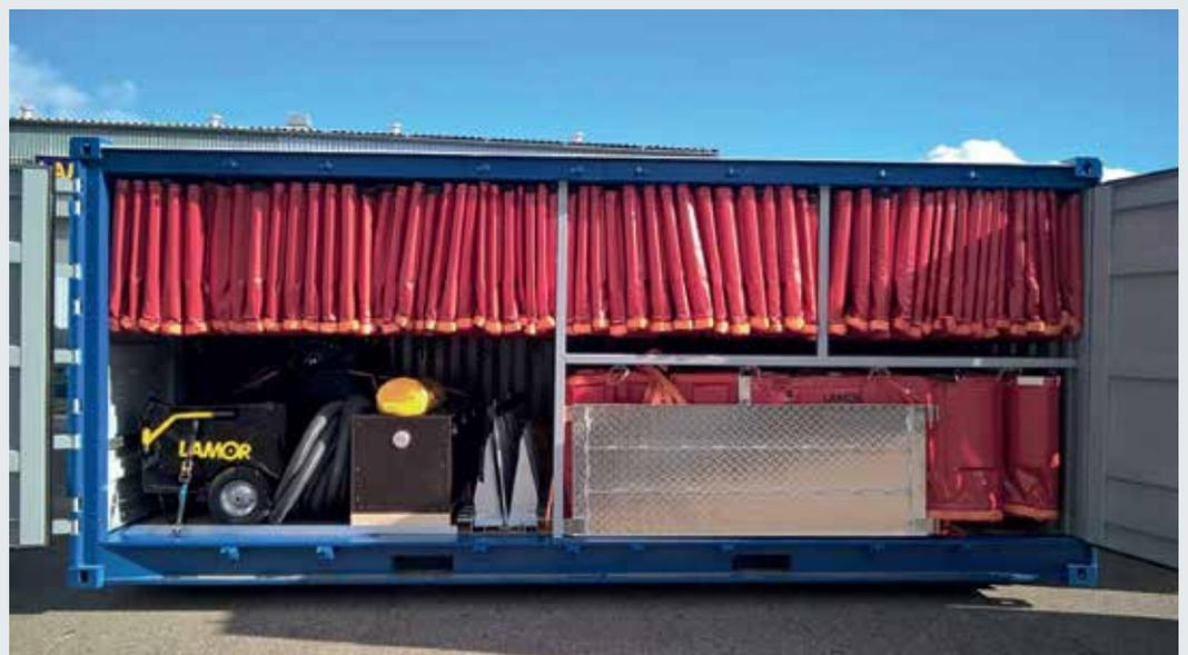
Schaumgefüllte Ölsperren, hängende Lagerung in einem Container
