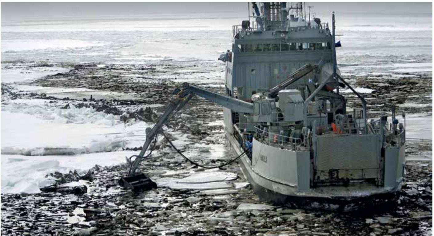
Bucketskimmer (LRB 250), Kapazität: 140 m<sup>3</sup>/h (616 gpm)
