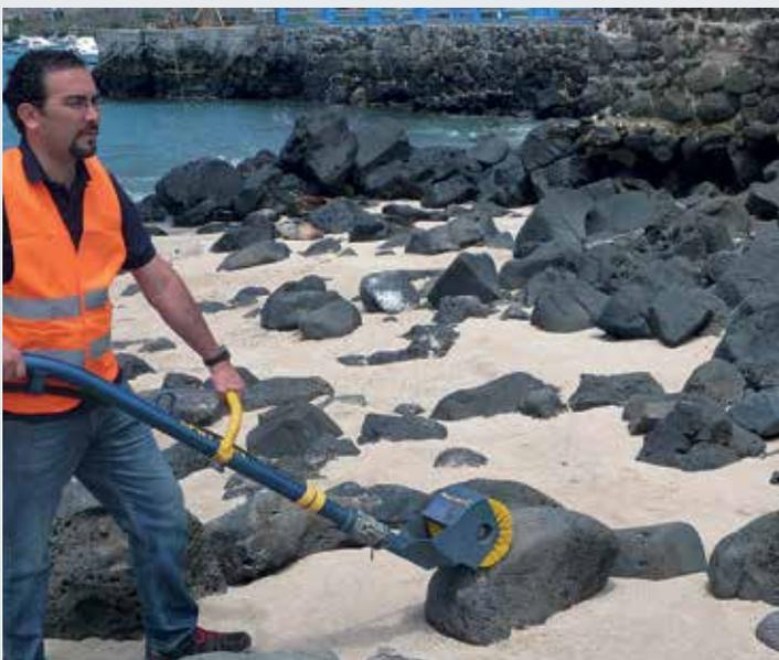
Rock Cleaner (LRC), Kapazität: 9,7 m<sup>3</sup>/h (43 gpm)
