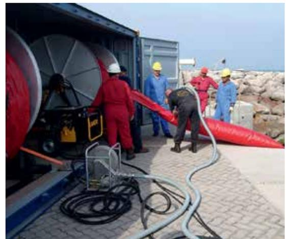
Aufblasbare Leicht-Ölsperre (PVC/PU oder CR), Höhe: 650 bis 1.650 mm
