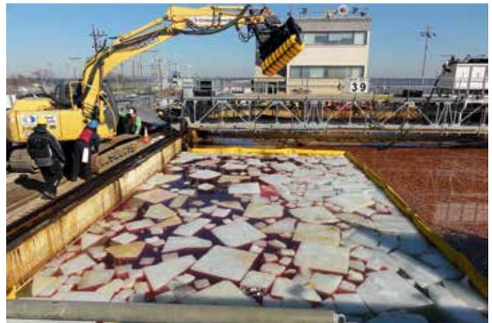
Bucketskimmer (LRB 150), Kapazität: 115 m<sup>3</sup>/h (506 gpm)
