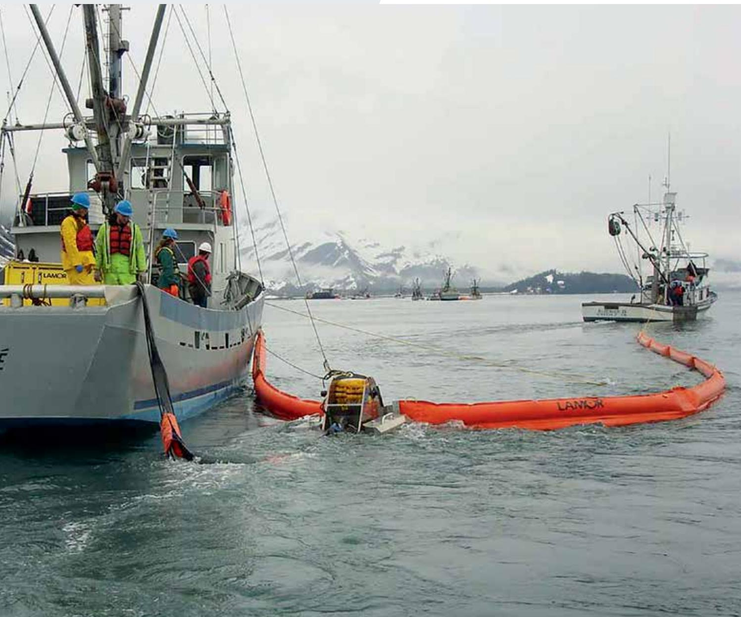
Multimax 50 (LAM 50), Kapazität: 50 m<sup>3</sup>/d (220 gpm)
