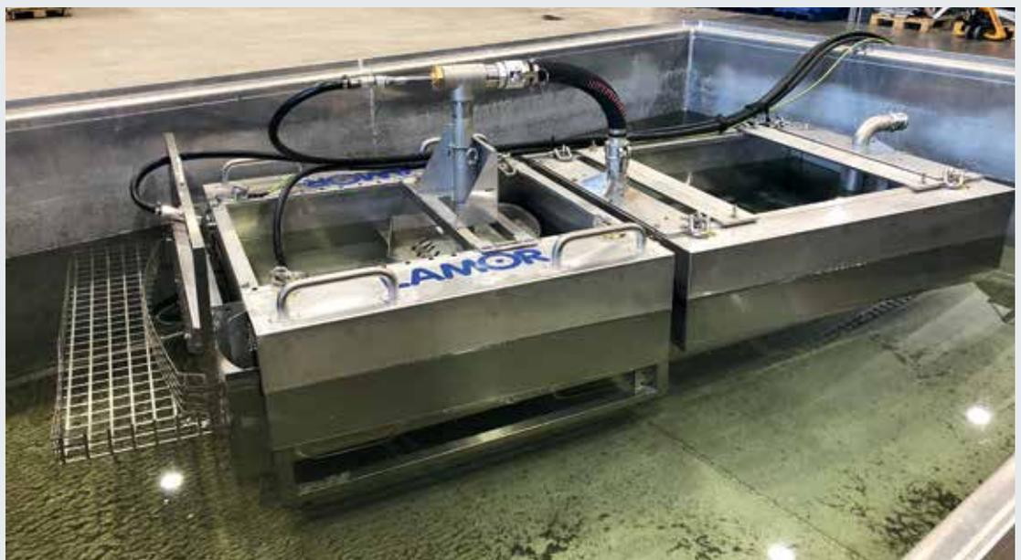
IPS Skimmer (IPS A) mit Luftdüse und Vakuum-Ejektor, Kapazität: 9,7 m<sup>3</sup>/h
