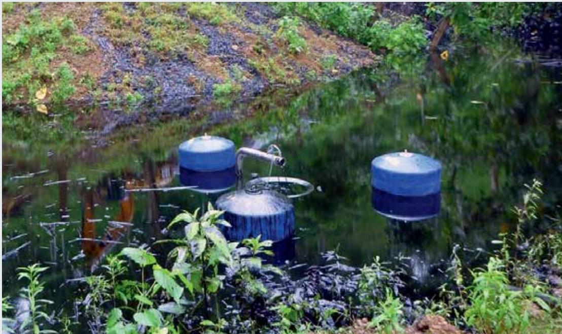
Wehrskimmer LWS 500, Kapazität: 70 m<sup>3</sup>/h (308 gpm)
