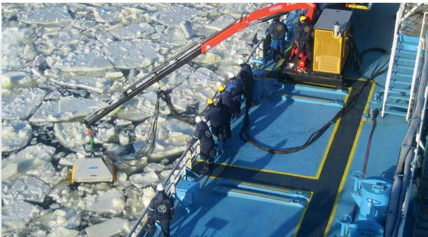
مكشطة القطب الشمالي المتجمد 125 (LAS 125)، السعة: 125 متر مكعب/الساعة (550 جالون/دقيقة)
