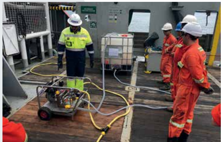
نظام لامور للتشتيت – يعمل بالكهرباء LDS 50-200
