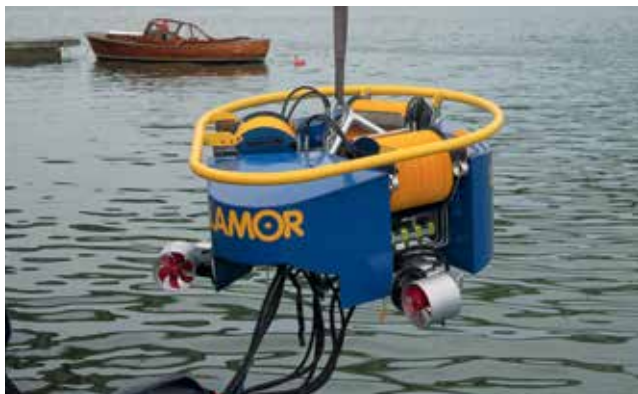
•Multimax 70 MK II (LMS 70 MK II) السعة: 75 متر مكعب/ساعة (330 جالون/دقيقة)
