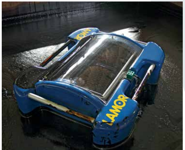
Minimax12 (MM12)، السعة: 12 متر مكعب/ساعة (52 جالون/دقيقة)
