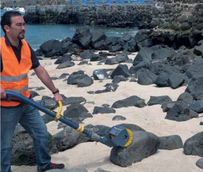
منظف الصخور لامور (LRC)، السعة: 9.7 متر مكعب/ساعة (43 جالون/دقيقة)
