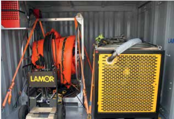
تشمل حلول الحاويات كل من مولدات الطاقة وبكرة الخرطوم وجهاز التحكم الهيدروليكي للمكاشط
