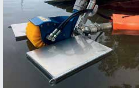
MicroMax، السعة: 9.7 متر مكعب/ساعة (43 جالون/دقيقة)
