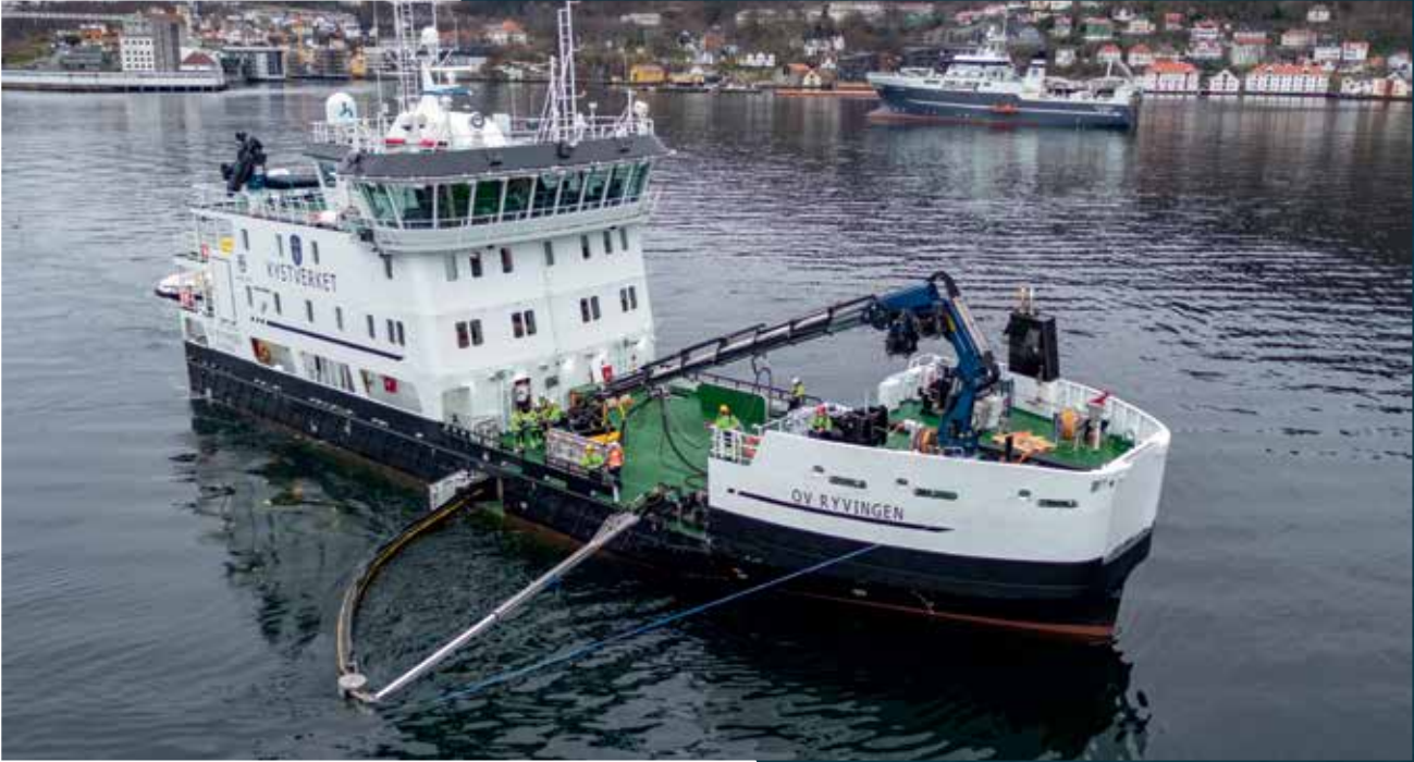
نظام لامور المُدمج لاستعادة النفط المُتسرب (LORS)
