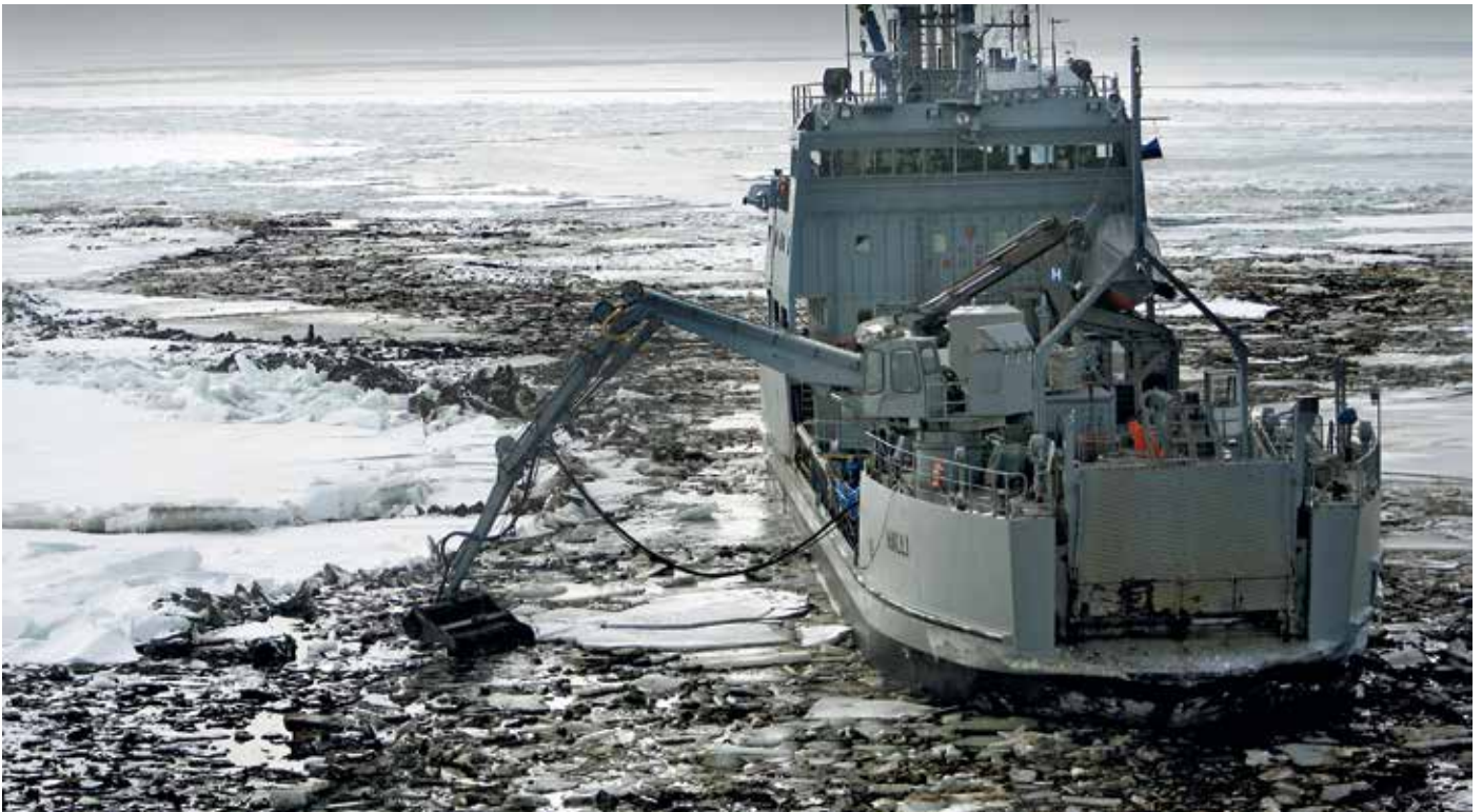
مكشطة جرافة استعادة النفط (LRB 250) Bucket Skimmer. السعة: 140 متر مكعب/الساعة (616 جالون/دقيقة)
