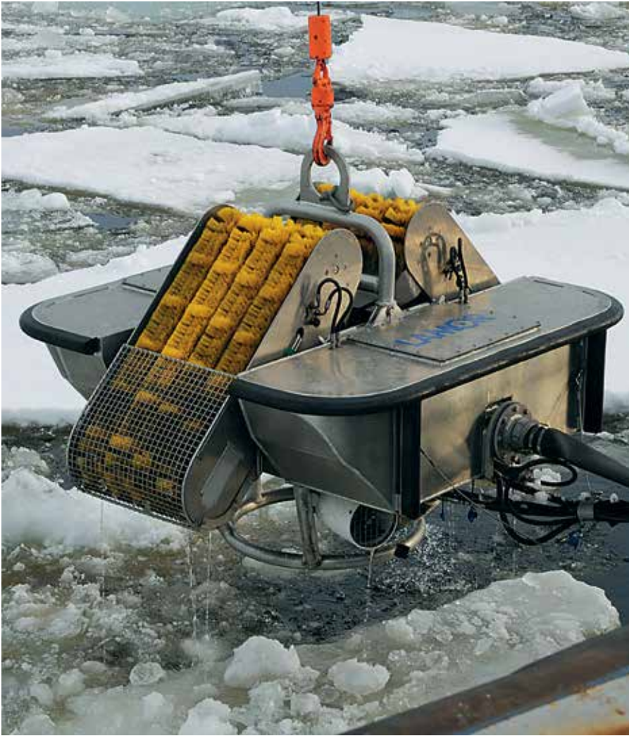
مكشطة الطفو الحر (LFF100) Free Floating 100، السعة: 111 متر مكعب/ساعة (489 جالون/دقيقة)
