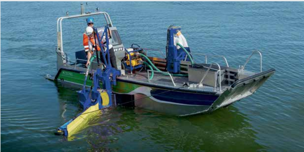
نظام الجمع الجانبي (MiniBagger / Side collector). السعة: 10 متر مكعب/ساعة (44 جالون/دقيقة)
