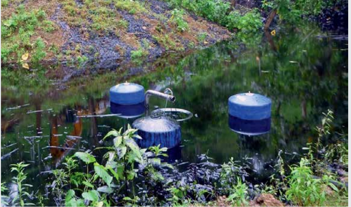
مكاشطة السدود Weirskimmer 500، السعة: 70 متر مكعب/ساعة (308 جالون/دقيقة)
