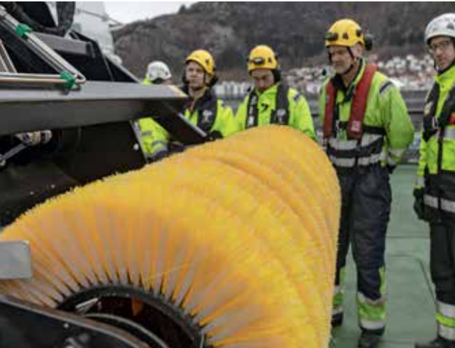
مكشّطة جرافة استعادة النفط المحمول على السفن (LRB 150)، السعة: 115 متر مكعب/ساعة (506 جالون/دقيقة)
