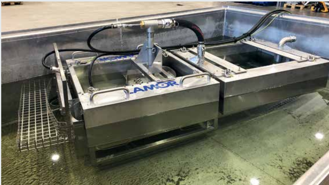
المكشطة الهوائية للعمليات الصناعية (IPS A)، السعة: 9.7 متر مكعب/ساعة (43 جالون/دقيقة)
