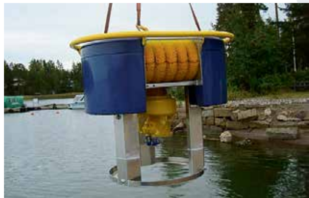
•Multiskimmer (LMS 50/70) السعة: 271.5 متر مكعب/ساعة (1195 جالون/دقيقة)
