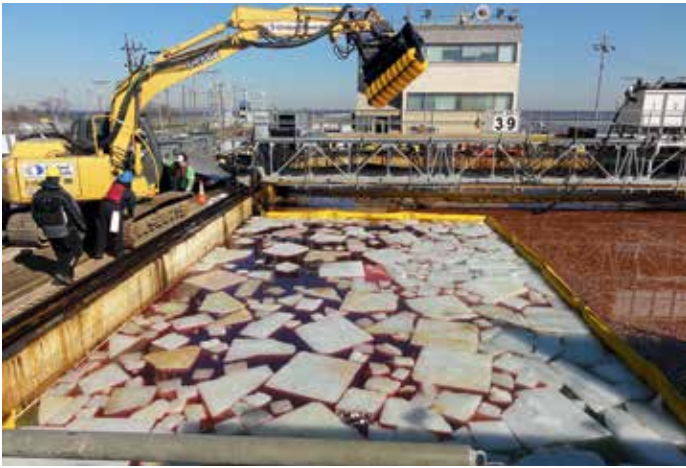
مكشطة جرافة استعادة النفط (LRB 150). السعة: 115 متر مكعب/الساعة (506 جالون/دقيقة)
