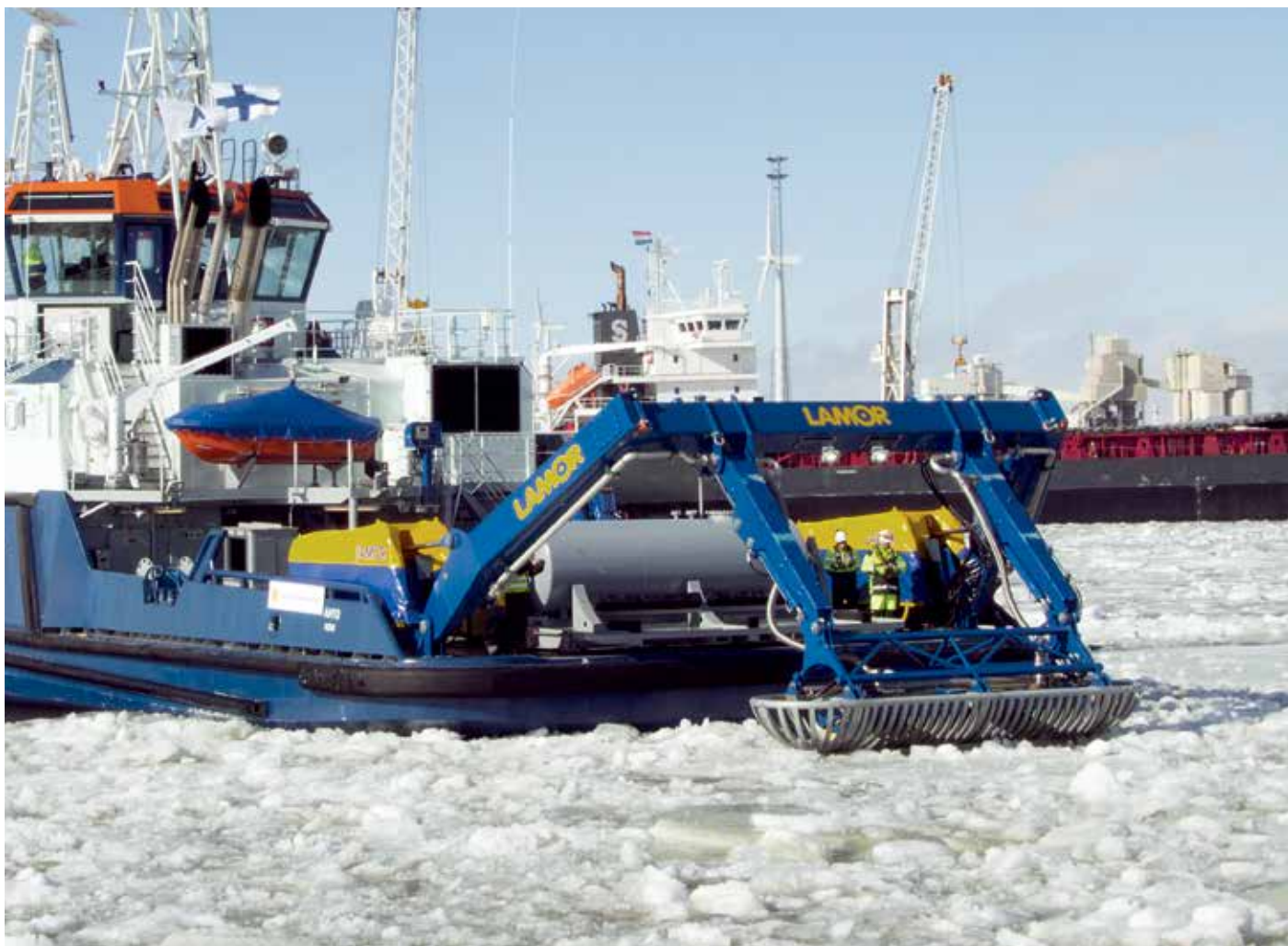
Sternmax، السعة: 560 متر مكعب/الساعة (2465 جالون/دقيقة)
