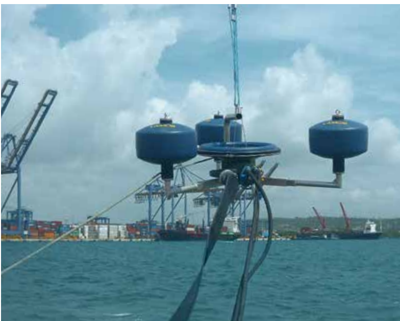
مكشطة السدود Weir Skimmer 800 (LWS 800)، السعة: 112.2 متر مكعب/ساعة (494 جالون/دقيقة)
