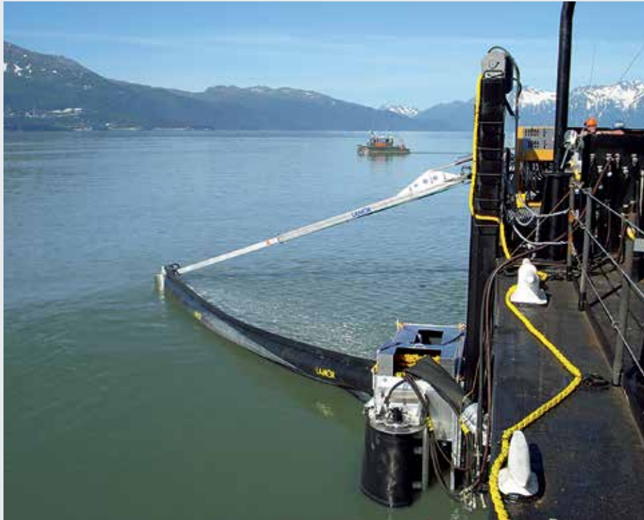
نظام الجمع الجانبي /الخزانة الجانبية للنفط المُتسرب (LSC)
