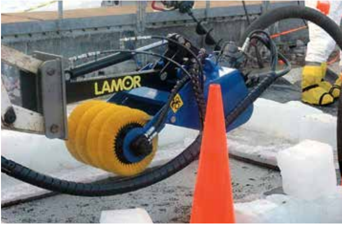
جرافة استعادة النفط لامور (LRB 40) Recovery Bucket 40. السعة: 19 متر مكعب/الساعة (83 جالون/دقيقة)
