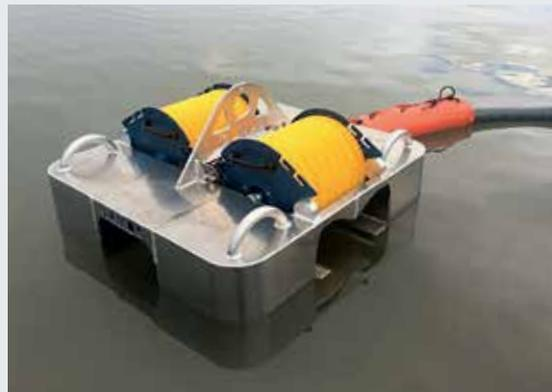
Minimax 50, capacità: 53,6 m<sup>3</sup>/h
