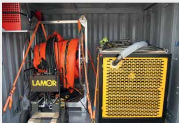
Soluzione containerizzata comprensiva di power pack, rullo avvolgitore e set di controllo idraulico per skimmer
