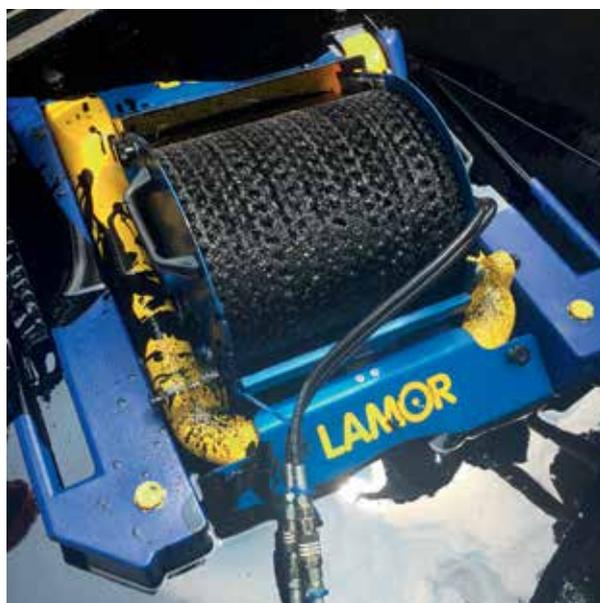
Mini max 25 (MM 25), capacità: 25 m<sup>3</sup>/h
