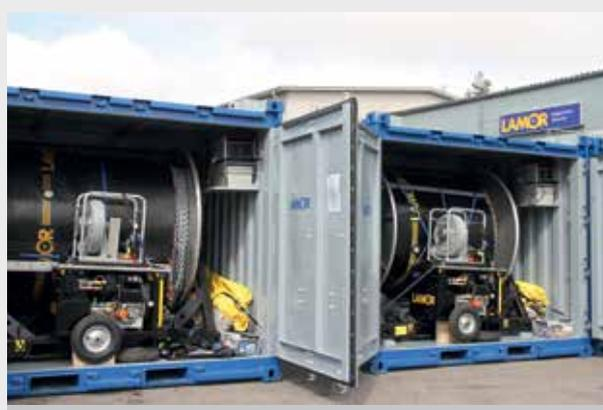
Soluzione containerizzata per barriere galleggianti per usi gravosi HDB 1500
