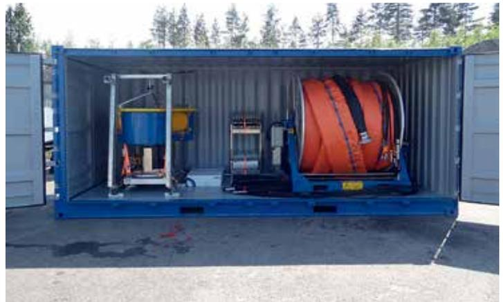
Rullo avvolgitore all'interno di un sistema containerizzato
