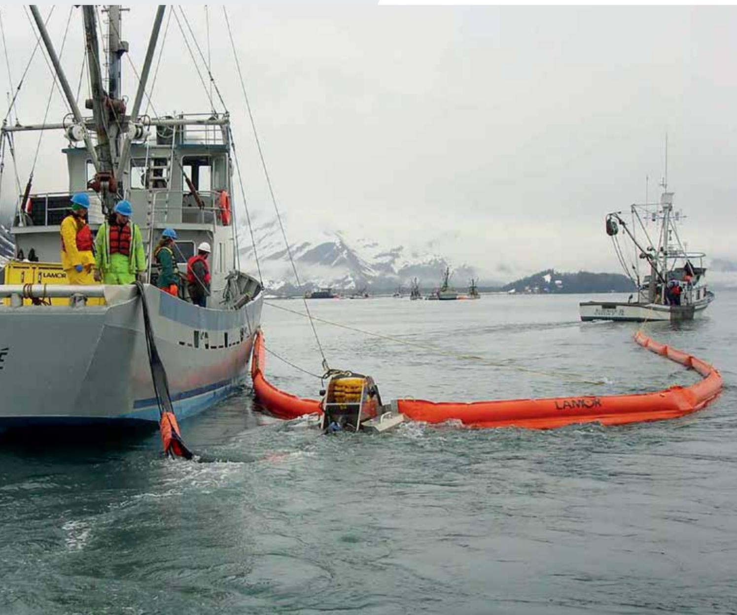
Multimax 50 (LAM 50), capacità: 50 m<sup>3</sup>/d
