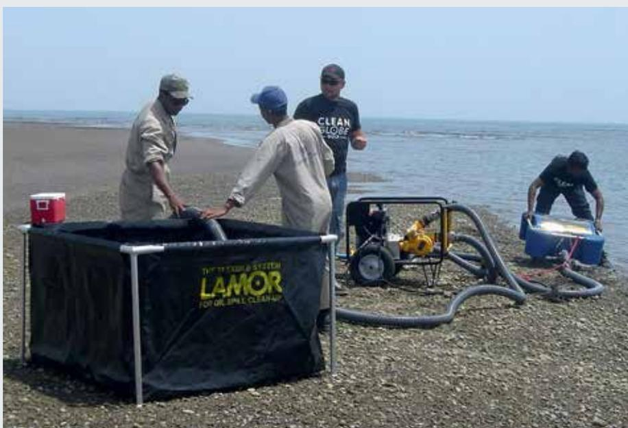
Serbatoio ripiegabile per lo stoccaggio degli idrocarburi, LPP 6 C 75, e skimmer Minimax 12
