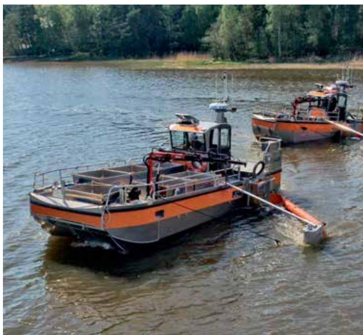
Imbarcazione da lavoro a pescaggio ultra-ridotto, dotata di cassetta laterale per il recupero degli idrocarburi
