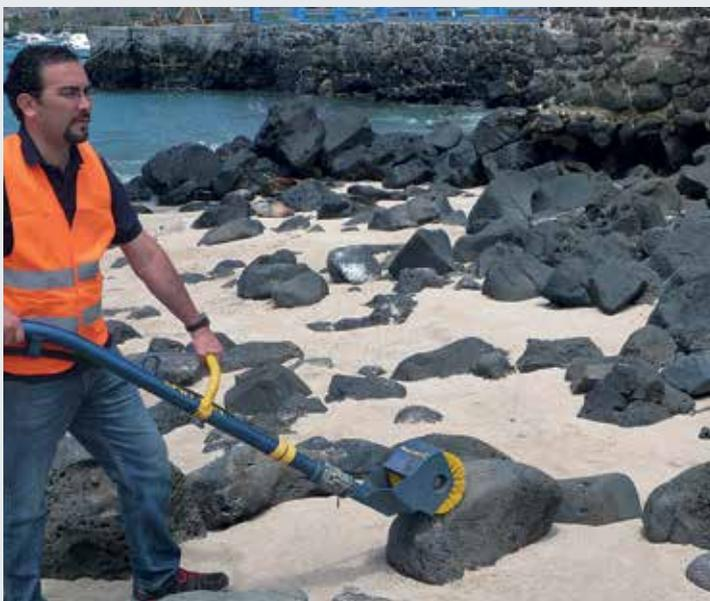
Rock Cleaner (LRC), capacità: 9,7 m<sup>3</sup>/h
