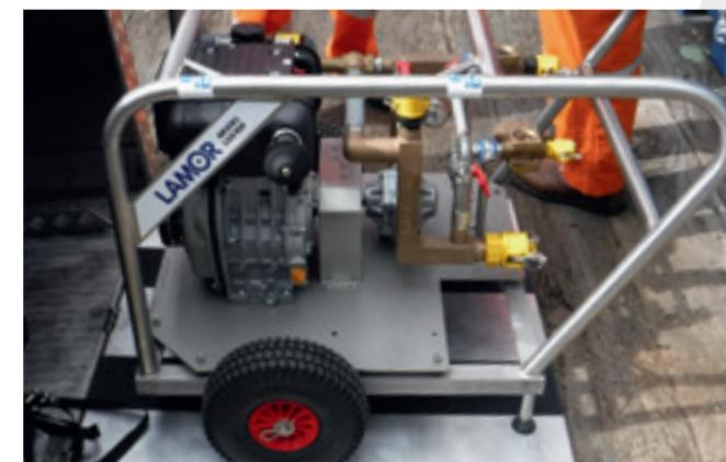
Дизельная установка нанесения диспергентов LDS 50-200
