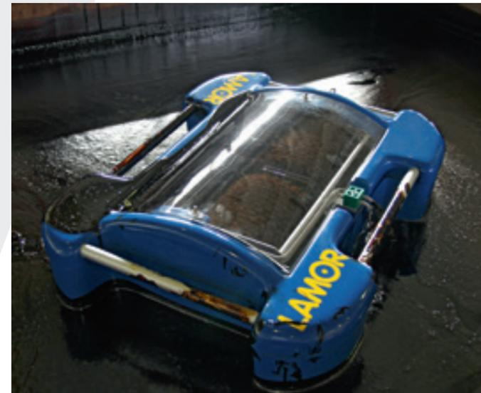
Нефтесборщик Minimax12 (MM12), производительность: 12 м<sup>3</sup>/ч
