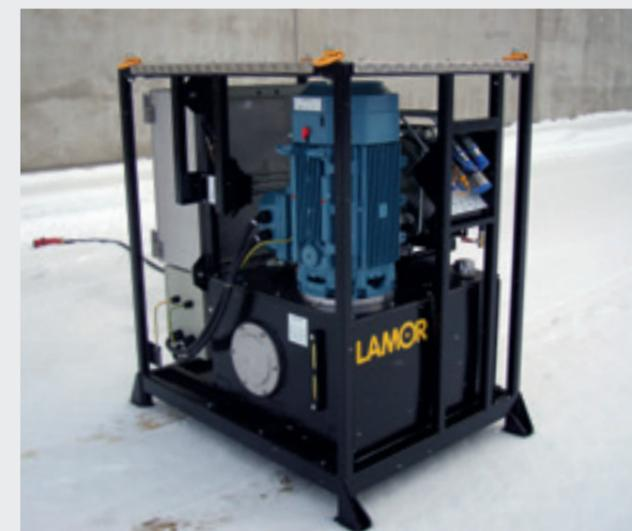
Электрический силовой агрегат LPP 22 E (29,5-40,2 л.с.)
