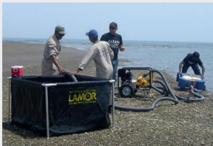
Складная емкость для временного хранения нефти, силовой агрегат LPP 6 со встроенным насосом C 75 и нефтесборщик Minimax 12
