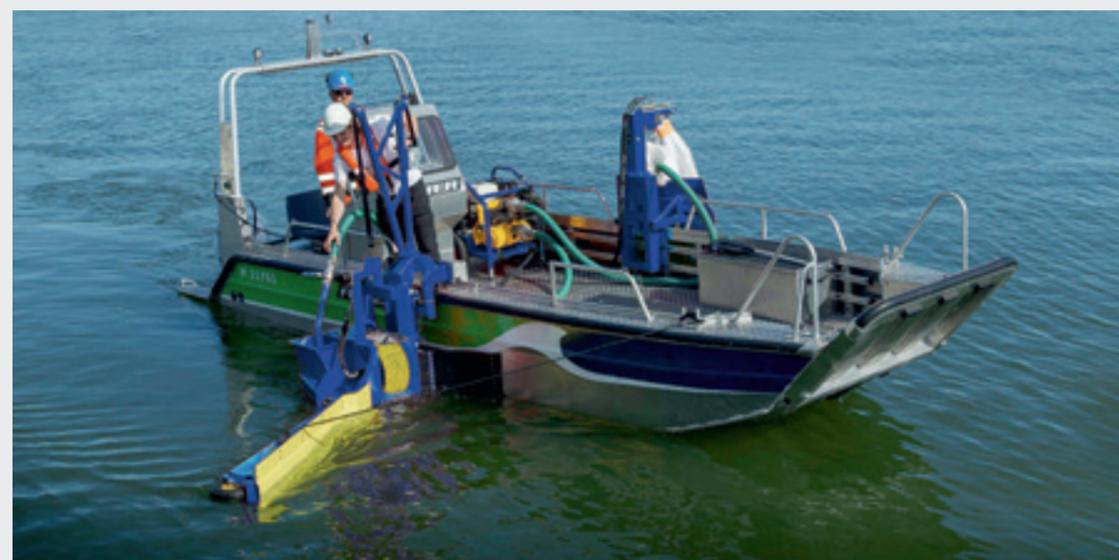
Бортовой нефтесборщик / MiniBagger, производительность: 10 м³/ч
