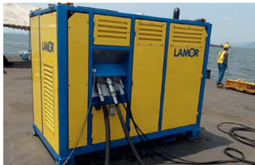
Силовой агрегат LPP 90 EX (121 л.с.) во взрывозащитном исполнении
