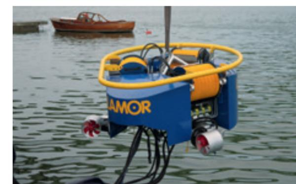
Нефтесборщик Multimax 70 МК II (LMS 70 МК II), производительность: 75 м<sup>3</sup>/ч
