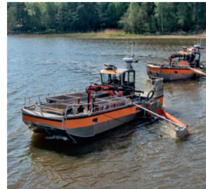
Рабочий катер Lamog со сверхмалой осадкой, оборудованный бортовой навесной нефтесборной системой
