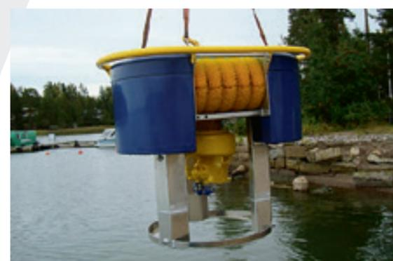
Нефтесборщик Multiskimmer (LMS 50/70), производительность: 271.5 м<sup>3</sup>/ч
