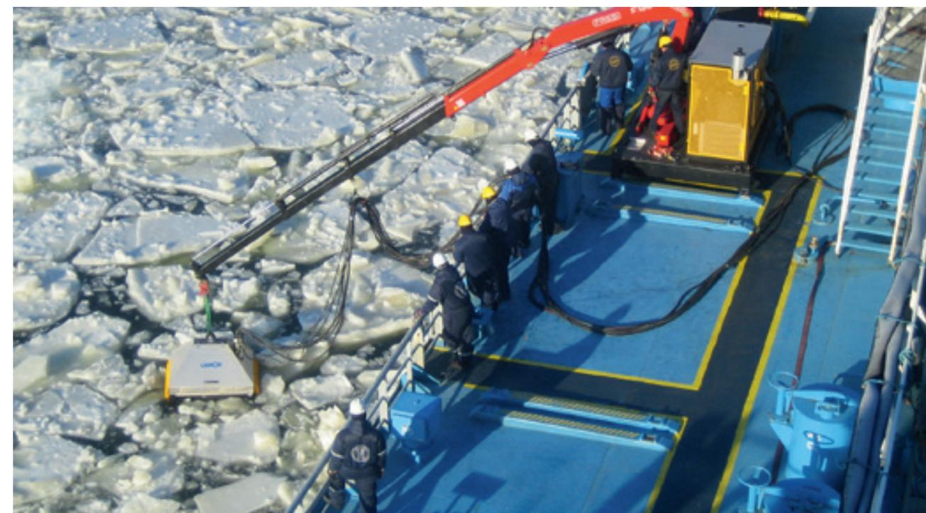
Арктический нефтесборщик LAS 125, производительность: 125 м<sup>3</sup>/ч
