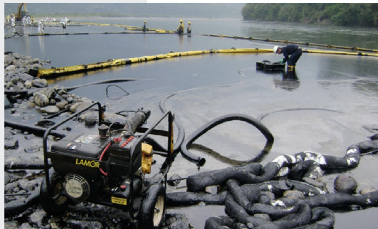
Силовой агрегат LPP 6, совмещенный с насосом C75, мощность: 5,4 кВт (7,2 л.с.)
