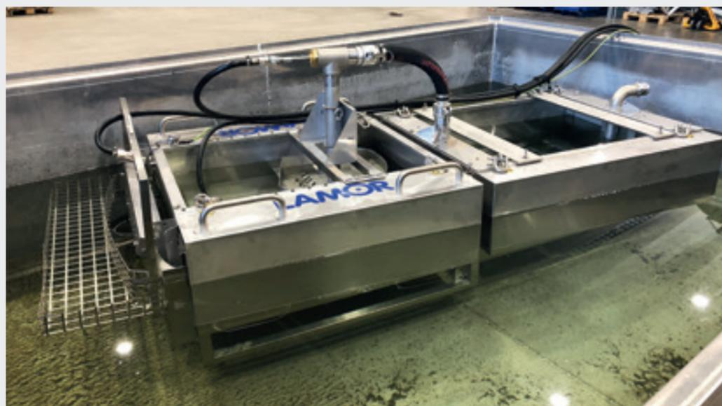
Промышленная нефтеочистительная воздушная установка IPS A, производительность: 9.7 м³/ч
