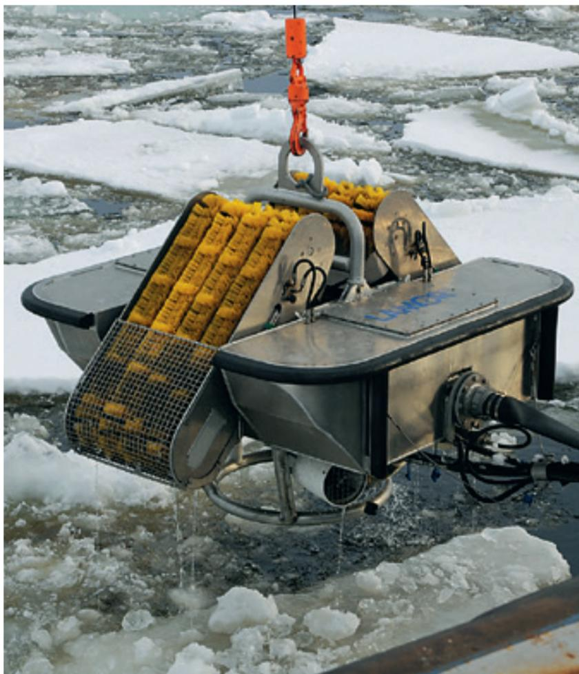
Свободноплавающий нефтесборщик LFF100, производительность: 111 м³/ч (489 грм)
