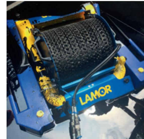
Нефтесборщик Minimax 25 (MM 25), производительность: 25 м<sup>3</sup>/ч
