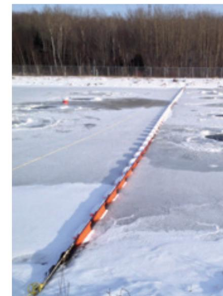
Плавающие перегородки, развернутые в ледовых условиях
