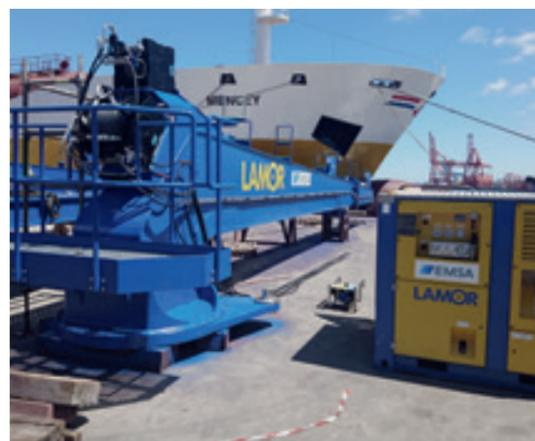
Силовой агрегат LPP 60 EX во взрывозащитном исполнении
