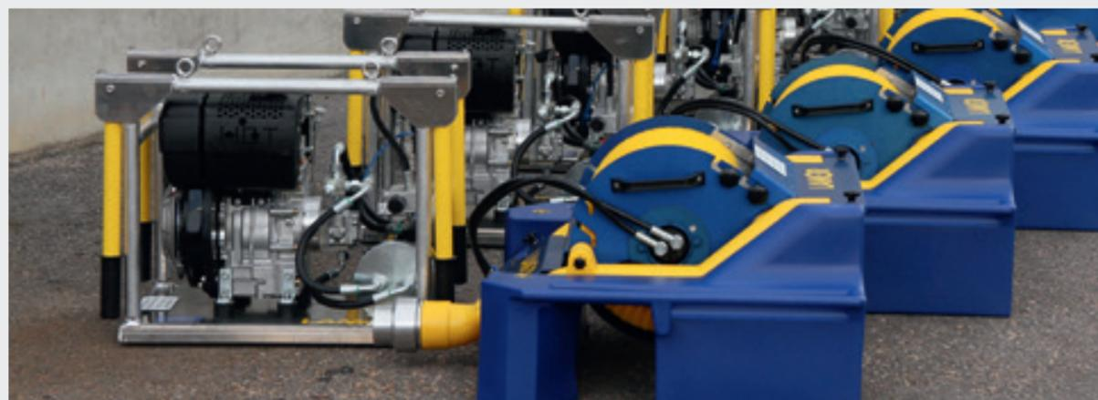
Силовой агрегат LPP 3.5, мощность: 3 кВт (4,7 л.с.) (и нефтесборщик Minimax 25)
