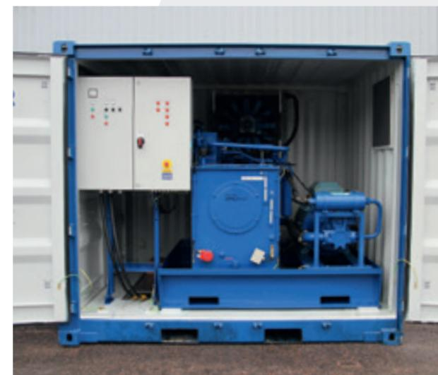
Электрический силовой агрегат LPP 90 E (100-148 л.с.)
