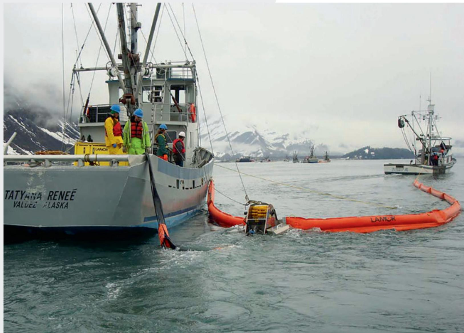
Нефтесборщик Multimax 50 (LAM 50), производительность: 50 м<sup>3</sup>/ч
