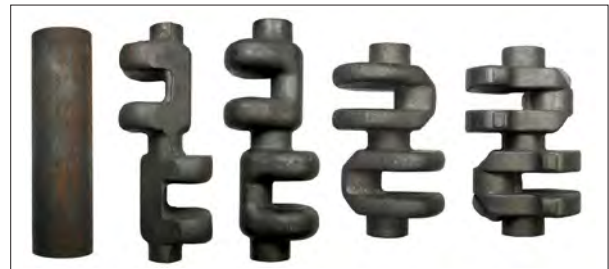
Figure 3 : Gamme de forgeage multidirectionnel d'un vilebrequin 2 cylindres Source : IPH
