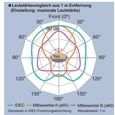
Der Alarm kann aus allen Richtungen gehört werden, da der Ton gleichmäßig ausgegeben wird.
