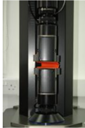
Trapezoidal tear specimen EN 1875-3
