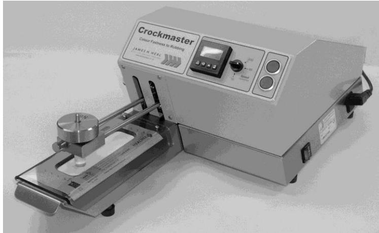
Materialien zu entsprechen. Das kombinierte und effektive Einspannen der einfach zu bedienenden Probenklemme aus Plexiglas und dem synthetischen Scheuerpapier macht das **Crockmaster** verwendbar für Textilien aus allen möglichen Fasern, in Form von Garn oder Gewebe, egal ob gefärbt, bedruckt oder anderswie farbig.
