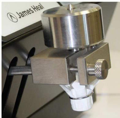
Der Reibfinger kann durch das Drehen der "Klemm-Schraube" gegen den Uhrzeigersinn entfernt werden, während der Klemmdruck gelöst ist. Ersetzen Sie den Reibfinger. Legen Sie den Klemmdruck wieder an, um den Finger zu sichern, indem Sie die Klemm-Schraube im Uhrzeigersinn drehen.
