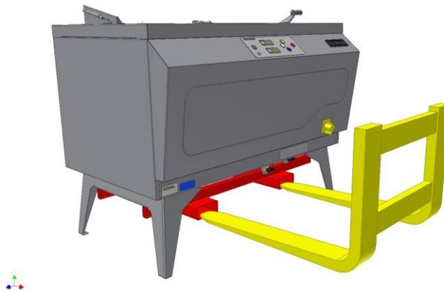
Inserire le forche del muletto all'interno delle due larghe incanalature senza arrivare a toccare la parte frontale dello strumento.
