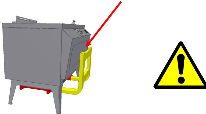
Sollevere e spostare lo strumento nella posizione desiderata all'interno del laboratorio. Smontare e rimuovere la struttura di sollevamento.
