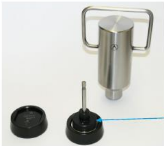
Assembler le porte-échantillon dans le système de serrage de manière habituelle, mais ne serrez pas si vous utilisez le poids de 5,5 kg
