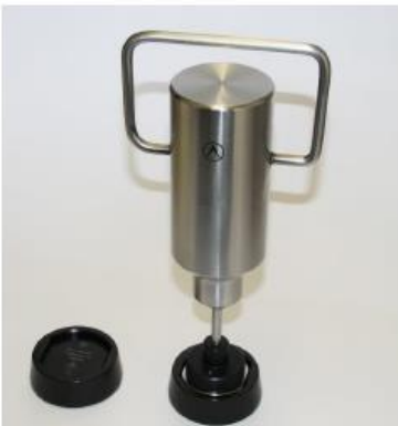
Si vous utilisez le poids de 5,5 kg, placez le poids sur la tige et serrez le Porte-échantillon
