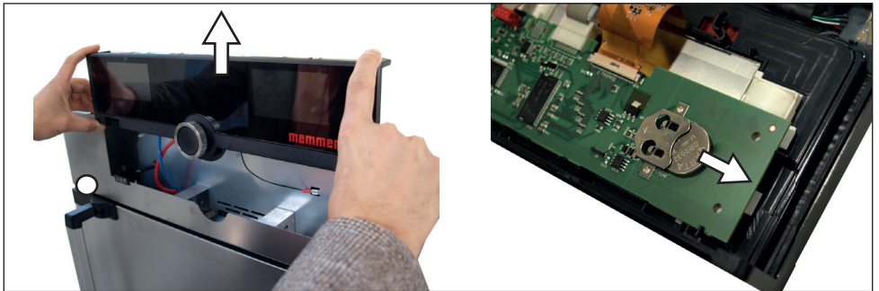
Fig. 25 Retirar la batería de litio
