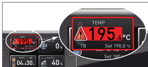
Fig. 19 Il monitoraggio della temperatura ha reagito
