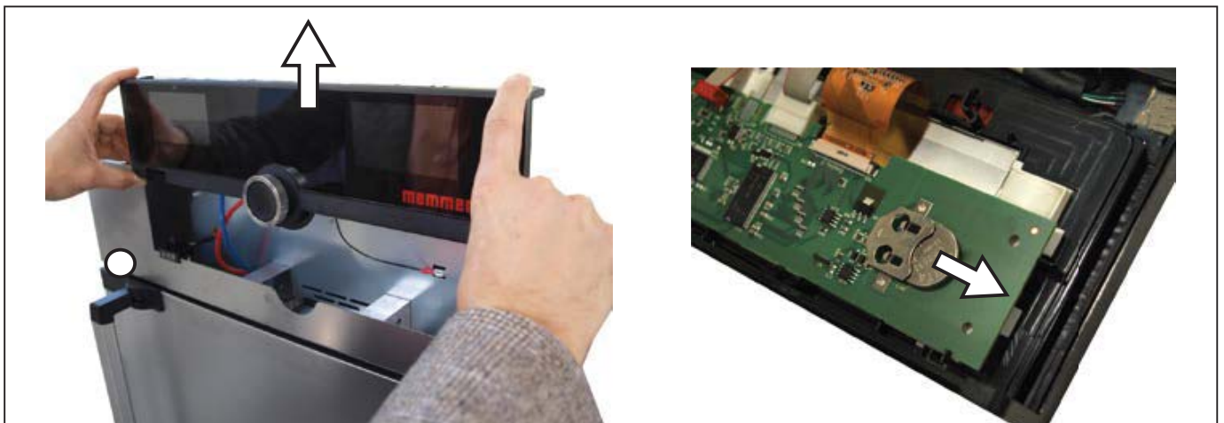
Рис. 25 Извлечение литиевого аккумулятора
