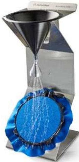
Der Sprühtester besteht aus einem Metallrahmen, in dem vertikal ein konischer Trichter von 150 mm Ø befestigt ist. Eine Metalldüse ist am Ausgang des Trichters befestigt.
