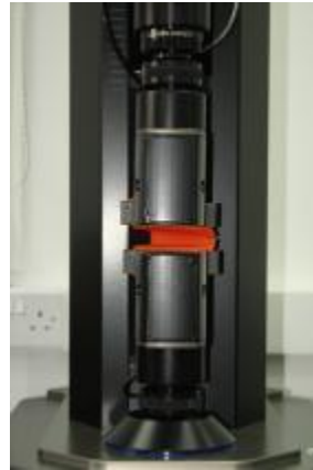
Trapezoidal tear specimen EN 1875-3
