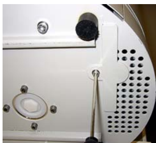
Fig. 46: Soltar la tapa del filtro del aire
