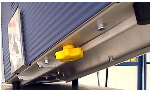
Fig. 5: Desatornillar la protección de transporte amarilla antes poner en funcionamiento el aparato
