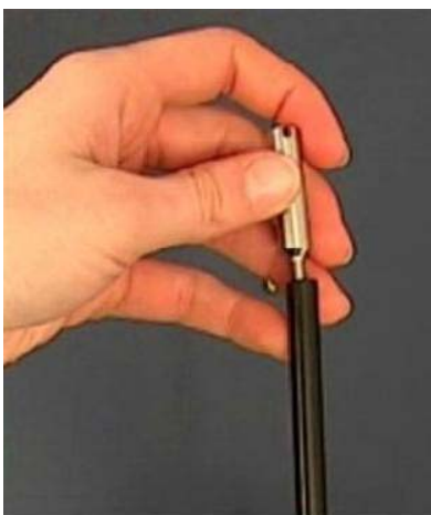
Fig. 8: Enrosca la punta adicional de protección contra el agua
