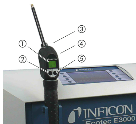
Fig. 4: Mango: pantalla y funciones
