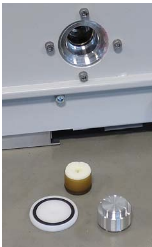
Fig. 49: Depósito de lubricante abierto
