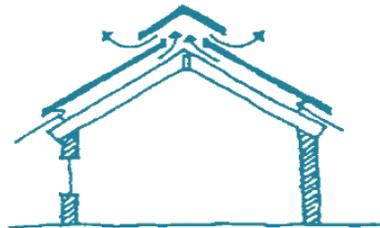
– Calor y ventilación: Por su formato el techo inclinado favorece mucho el efecto chimenea y la reducción de la temperatura en el interior del edificio.
