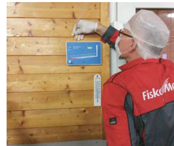
Biletet viser Erik Damsted, SEGES, som har forbunde trykket over isolasjonen på loftet med trykket i husdyrrømmet. Verdien viser svakt over null. All ventilasjon er slått av.
